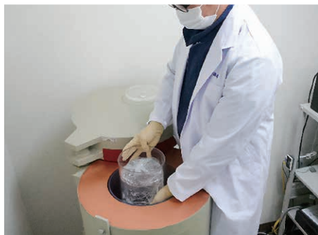
ゲルマニウム半導体検出器 放射性物質の種類と量を検査
