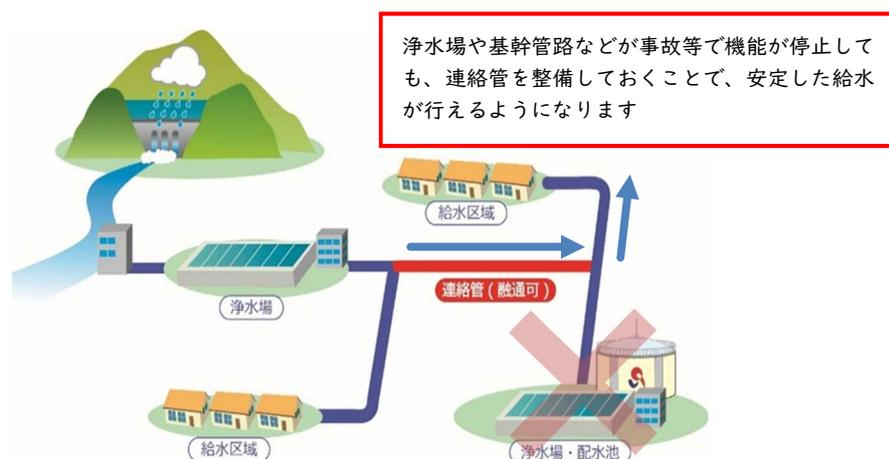
図 9 連絡管によるバックアップ機能強化
