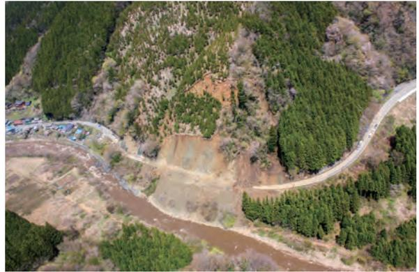
写真3-22 誘発地震で主要地方道いわき石川線が寸断・田人町石住字才鉢 [平成24(2012)年4月 陸上自衛隊第8普通科連隊提供]
