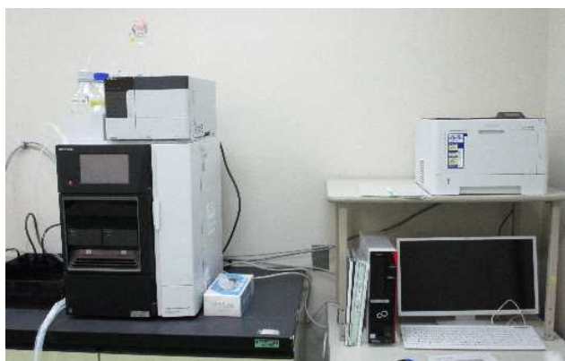
水質検査機器類の更新① (高速液体クロマトグラフ分析装置)
