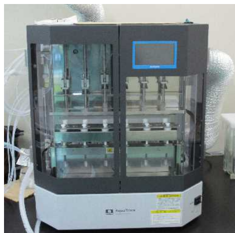
水質検査機器類の更新② (自動固相抽出装置)
