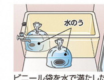
ビニール袋を水で満たした「水のう」でトイレやお風呂の排水口を一時的にふさぐことで、下水の逆流を防ぐ。
