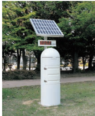
写真4-97 公共施設に設置した空間線量計 [平成24(2012)年5月 いわき市撮影]
