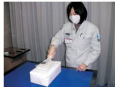
写真3-73 工業製品の残留放射線を測定
