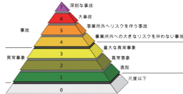
図3-9 国際原子力事象評価尺度
