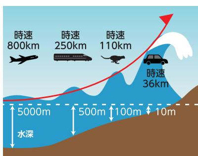
津波は、海が深いほど速く伝わります。沖合ではジェット機ほどの速さで波が伝わります。水深が浅くなるほど遅く伝わるため、**津波が陸地に近くにつれ**、減速した波の前方部に後方部が追いつくことで**波高が高くなります**。
