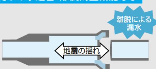
ロックリングと挿し口突部の引っ掛けりがないため、地震の揺れにより継手部分が離脱して、漏水の一因となることがあります。
