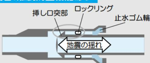
送・配水管の耐震化には離脱防止継手を使用した「耐震管」が効果的です。地震の揺れにあわせて、動くとともに、ロックリングと挿し口突部の引っ掛けりで、水道管をつなぐ継手部分の離脱を防止します。
